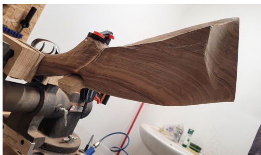
Tvarování pažby pomocí dlát a rašple
