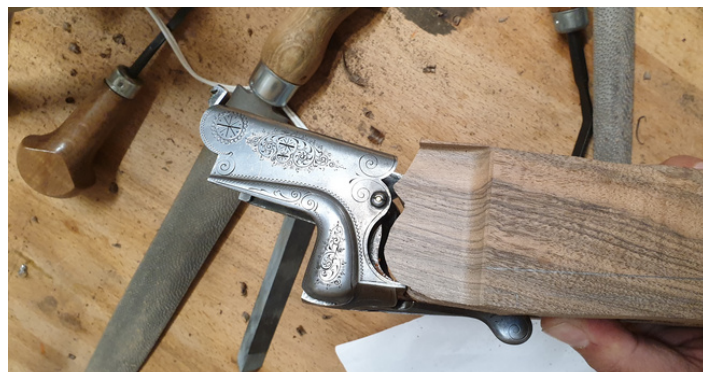
Zapažbení baskule do zádlabu – pomocí dlát
